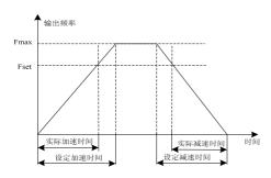
图6-2 加减速时间示意图
