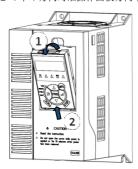
图 2-3 操作面板的拆卸
