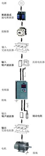
图 3-1 产品与外围器件的连接图
