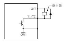
图 3-12 内部 24V 电源连接方式
