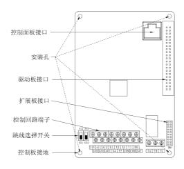
图 3-16 控制板示意图
