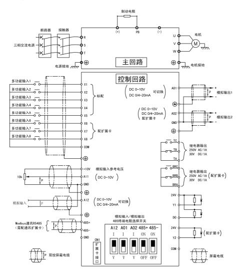
图 3-7 端子配线图 (以 ZKD8000-T4015G/018P 及以下型举例)
