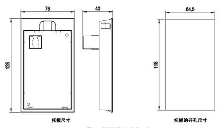
图 1-5 托板的外形和安装尺寸
