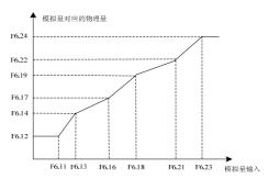
图 6-17 模拟输入非线性曲线
