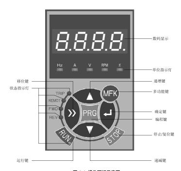
图 4-1 操作面板示意图
