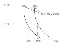
图6-26 电机过载保护系数设定
