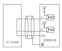
图 3-10 控制回路端子接线说明
