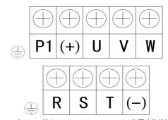
图 3-4 三相 400V 输入 160G/200P~500G/560P 主回路接线端子
