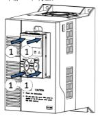
图 2-4 操作面板的安装
