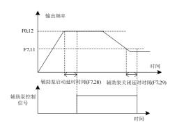
图6-21 恒压供水辅助泵控制信号
