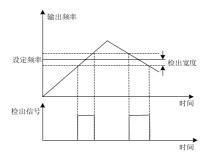
图 6-19 频率到达检出宽度示意图
