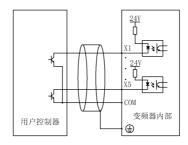
图 3-11 NPN 型共发射极连接方式
