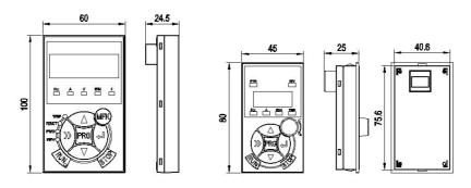
图 1-4 大、小操作面板的外形和安装尺寸
