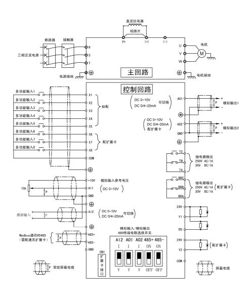
图 3-8 端子配线图 (以 ZKD8000-T4018G/022P 及以上型举例 )
