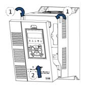
图 2-5 下盖板的拆卸
