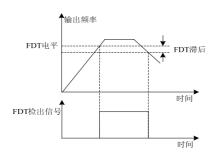
图6-20 FDT电平示意图
