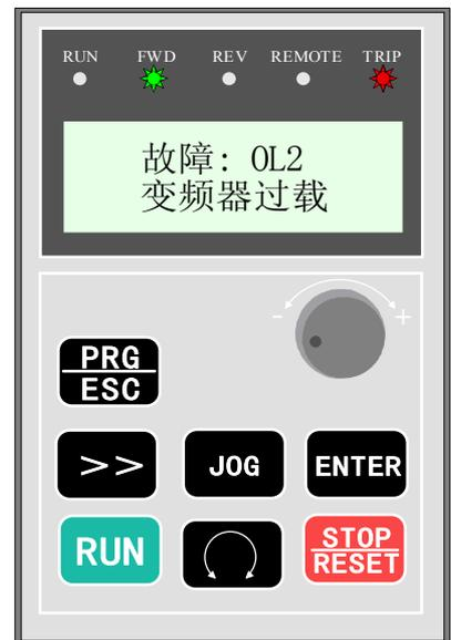
图6 故障时，显示故障代码及故障名，TRIP故障指示灯闪烁
