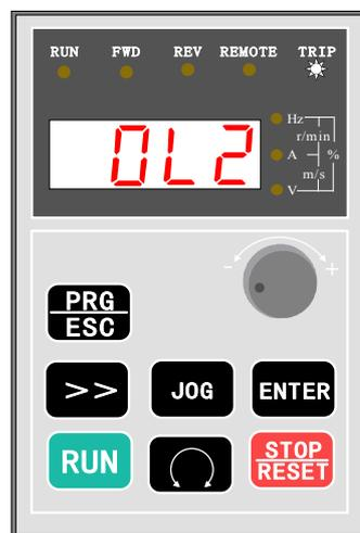
图6 故障时，显示故障代码
