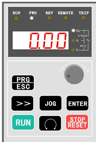
图2 停机状态，RUN灯熄灭
